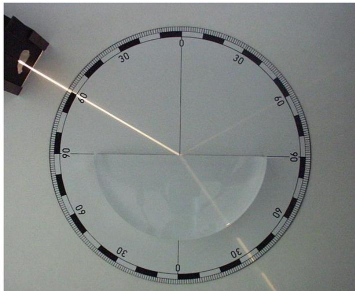
1) légénder le dessin ci-contre avec les mots suivants : rayon incident, rayon réfracté, rayon réfléchi, point d'incidence I, normale au dioptre au point I, angle d'incidence  $i_1$ , angle de réfraction  $i_2$ , angle de réflexion  $i_r$ , dioptre.
