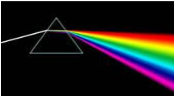
Le prisme est constitué de deux surfaces de séparation. La première est la surface air-verre, appelée face d'entrée du prisme et la seconde est la surface verre-air, appelée face de sortie. Le rayon lumineux incident subit une première réfraction sur la face d'entrée et une deuxième réfraction sur la face de sortie. La lumière incidente est blanche elle est constituée d'une somme de radiations lumineuses .
