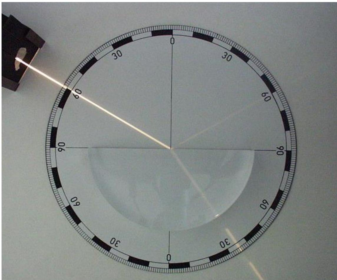
1) légènder le dessin ci-contre avec les mots suivants : rayon incident, rayon réfracté, rayon réfléchi, point d'incidence I, normale au dioptre au point I, angle d'incidence  $i_1$ , angle de réfraction  $i_2$ , angle de réflexion  $i_r$ , dioptre.
