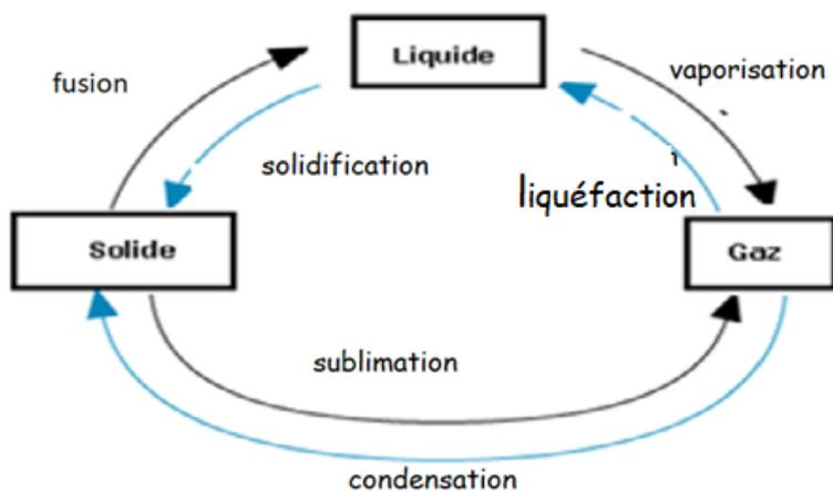
Compléter le diagramme des changements d'états avec les mots : sublimation, condensation, vaporisation, fusion, liquéfaction, solidification.
