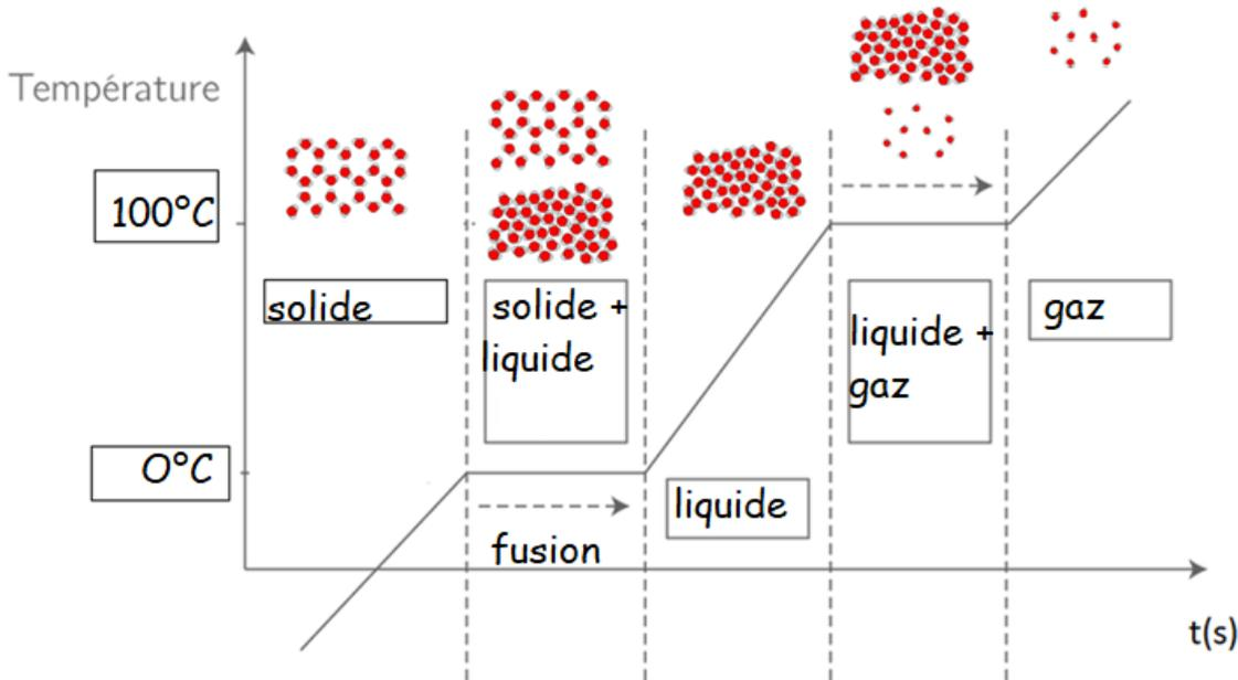
**Exemple** : on chauffe de l'eau initialement sous forme solide à une température inférieure à 0°C. Le graphe ci-dessous représente l'évolution de la température au cours du temps. 1) Dans les cadres et sur les 2 flèches, compléter le schéma avec les expressions suivantes : vaporisation, 0°C,
