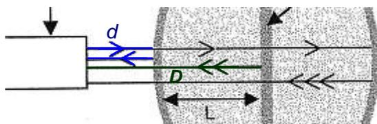
À la date  $t_1 = 10,0 \mu\text{s}$ , le 1<sup>er</sup> écho (pic  $P_1$ ) est perçu, l'onde a parcouru une distance égale à  $2d$ .
