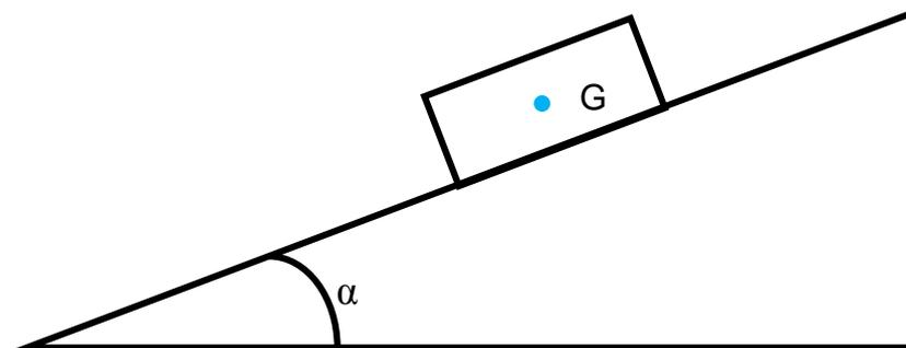
Schéma du contact ski-neige sur une pente, inclinée d'un angle  $\alpha$  par rapport à l'horizontale
