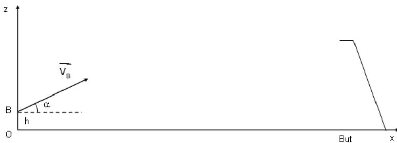
Au point B, la balle quitte la crosse à la date  $t = 0$  avec le vecteur vitesse  $\vec{V}_B$  contenu dans le plan  $(xOz)$  :. On néglige toutes les actions liées à l'air. On étudie le mouvement du centre d'inertie  $G$  de la balle dans le champ de pesanteur supposé uniforme. Le système d'axes utilisé est représenté sur le schéma ci-dessous : l'axe Ox est horizontal
